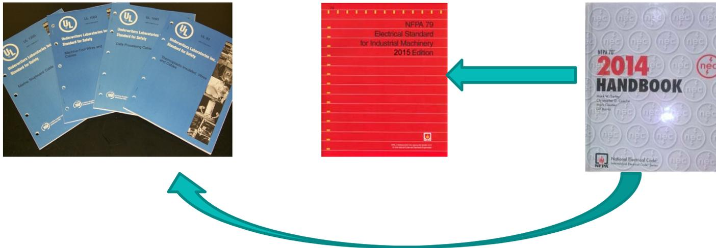
認証(リステッド)製品は、NECに従い、正しく取り付けられ、AHJ(NEC90.7)による承認の根拠となります。
