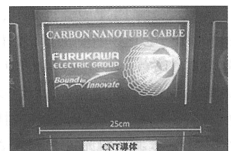
開発品への導通による LED の発光
