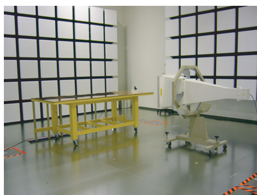
図5 ALSEを用いた電磁波耐性試験の様子
