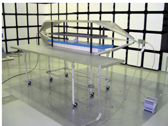
図 7 ストリップラインを用いた電磁波耐性試験の様子
