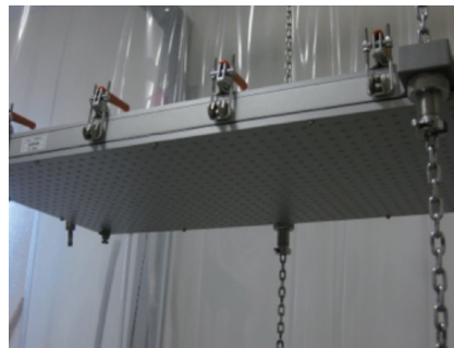
IPX1, X2: ドリップボックス試験装置
