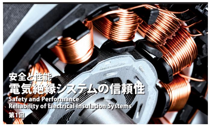
モータ、トランスフォーマ、発電機、ソレノイドなどの電磁気装置において安全性と性能における信頼性は不可欠な要素であり、これらの装置に使われている電気絶縁システム (Electrical Insulation System: EIS) は、要となる重要な機能であると言えます。EISとは、電気機器に使われる電気絶縁材料 (Electrical Insulation Material: EIM) が密接に組み合わされたもので、その機器の最高動作温度以下で作動することが要求されます。EISの例としてトランスフォーマ内のマグネットワイヤ、接地/巻線間絶縁材料、含浸樹脂などの組み合わせが挙げられます。
