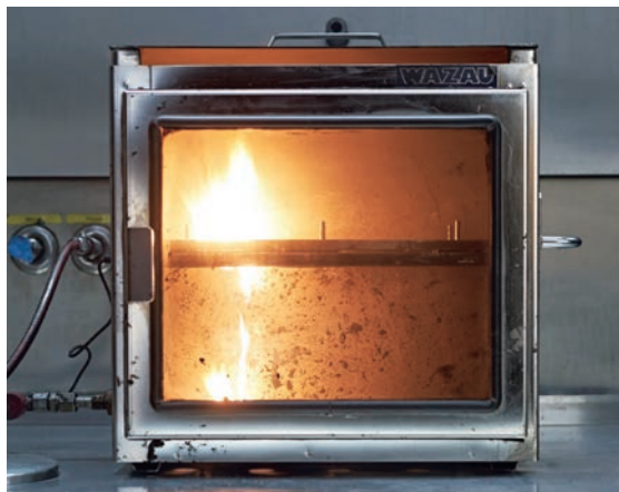
図 1 FMVSS 302 燃焼性試験
