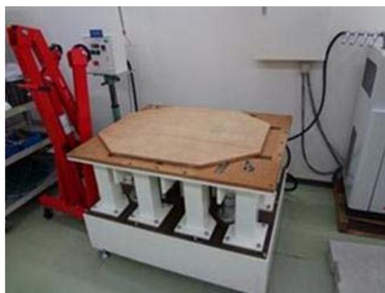
サンプルを50mm持ち上げ繰り返し落下させる試験装置です。
