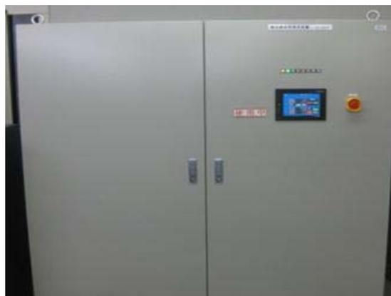
主にリレー、スイッチなどの接点開閉試験に用いられる力率可変負荷装置です。
