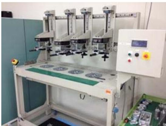
コネクターや端子台の電氣的接続部に対する機械的強度試験を行う試験装置となります。
