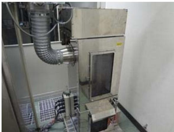
バッテリーサンプルに丸棒を置きその上に約9kgの錘を落下させます。
