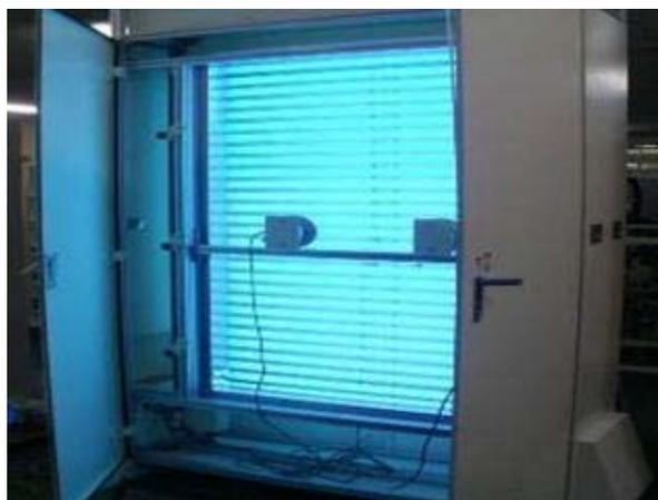
太陽光モジュール表面に対して紫外線を照射します。
