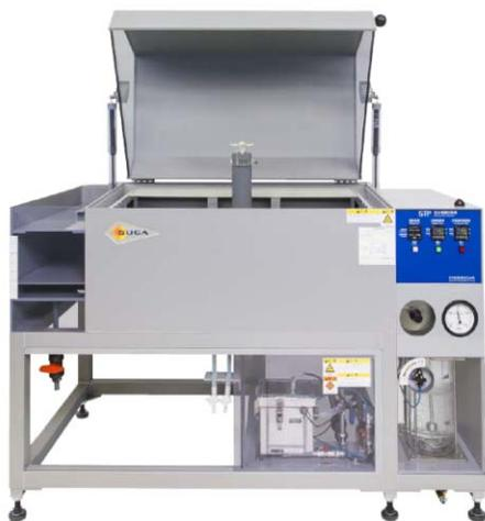
金属材料またはめっき皮膜・塗装皮膜を施した部品・製品の耐食性を評価する試験器です。
