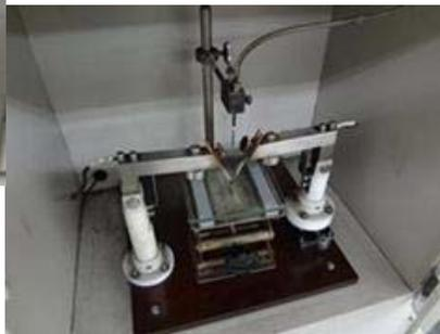
トラッキング破壊の確認を行う試験装置です。
