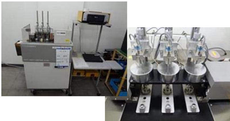
油中で樹脂材料にテストピン / 荷重棒を押し当て、荷重をかけながら油温を上昇させ軟化性を確認します。
