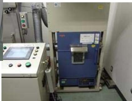
バッテリーセルサンプルを分解し内部にニッケル小片を埋め込んだ状態で加圧します。
