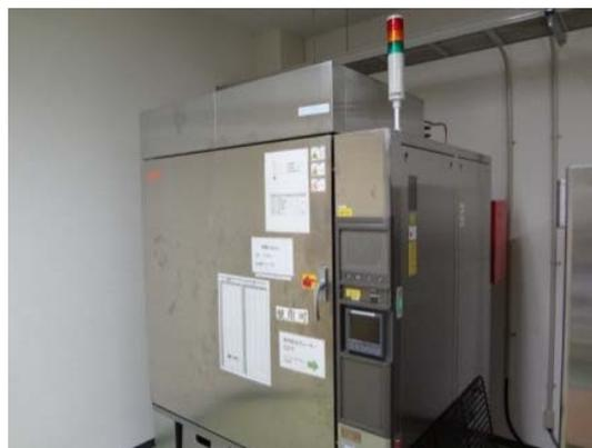
放爆弁、自動消火装置、ガス検知器、安全扉などバッテリーの爆発に備えた安全機能付恒温槽です。
