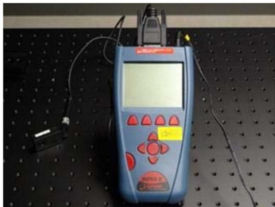
レーザークラスを判定するためにレーザーパワーを測定します。
