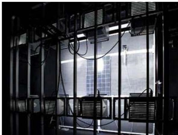
太陽光モジュールの温度試験を行うための定常光の太陽光シミュレーターです。
