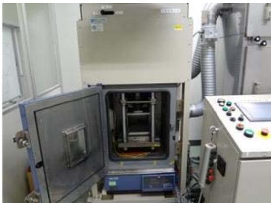
バッテリーサンプルを二枚の平板で13 kNで加圧します。
