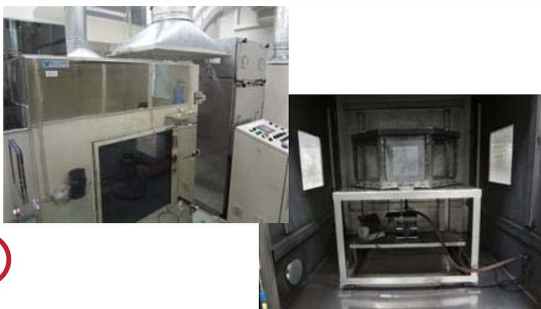
バッテリーサンプルを八角形のケージに入れバーナーで直接、加熱します。
