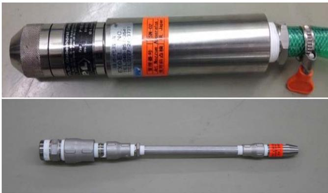
第二特性数字に対する水の浸入に対するIPX5, X6の評価試験器です。
