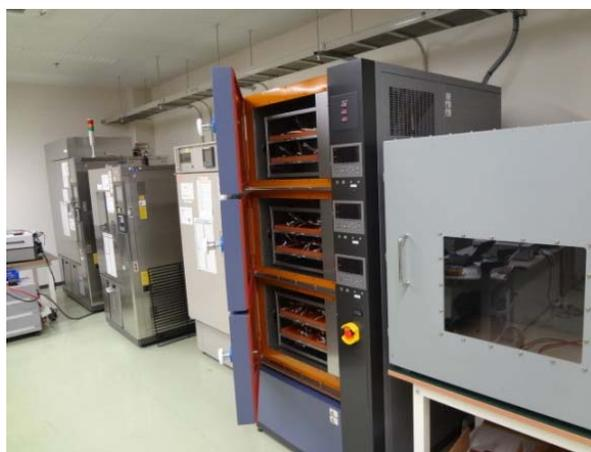
主に大容量バッテリーセルを充放電する24chの充放電システムです。
