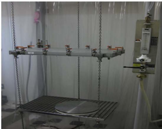
第二特性数字に対する水の浸入に対するIPX1, X2の評価試験器です。
