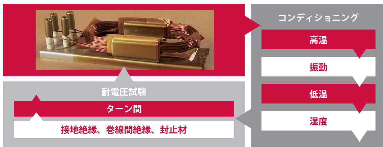
図2:熱劣化試験サイクル
