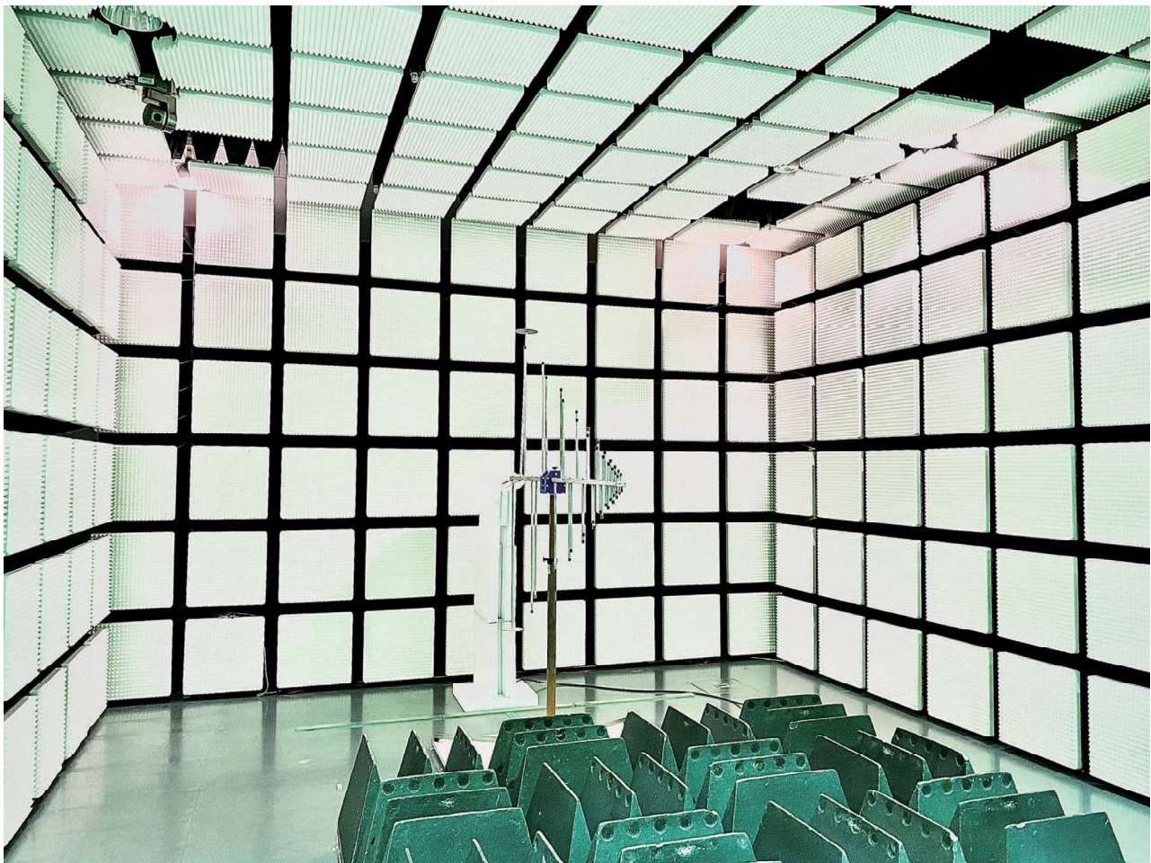
放射電磁界イミュニティ試験の様子（電波暗室内に設置された放射用アンテナ）
